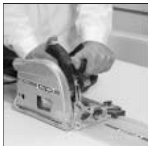
Žaganje s cirkularko (nastavljivo število vrtljajev)
