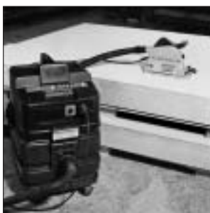
Cirkularka z odsesovalno napravo
